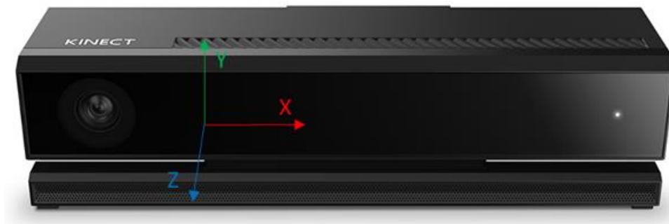
Figura 6.- Sistema de coordenadas de posición [28]
