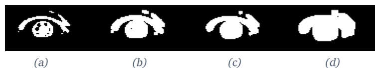
Figura 50 Operaciones morfológicas aplicadas para localizar los ojos. (a) Imagen tras aplicar la umbralización. (b) Imagen después de aplicar la primera dilatación. (c) Imagen tras aplicar el opening (d) imagen tras aplicar la segunda dilatación. Corresponde a la imagen de la Figura 49(c).
