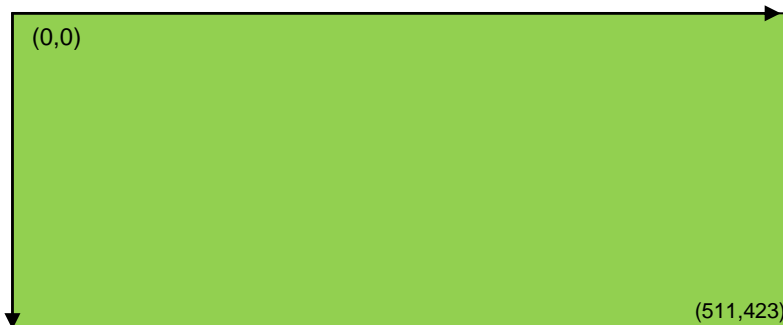
Figura 45. Sistema de coordenadas DepthSpace
